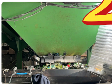
②コンベアに乗せて、ビン以外のものが混ざっていないか機械を使って確認する。
